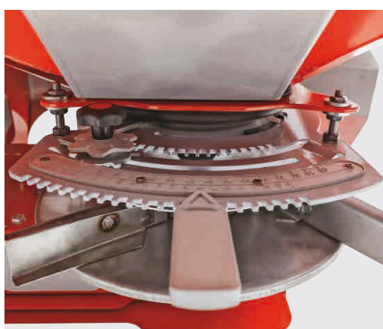
Oprema za nastavev stopnje trosenja na zadnji strani stroja je preprosto dosegljiva in nastavljiva.
