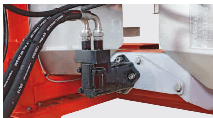
Centralni hidravlični pogon (Exacta HL/TL/GEOspread)
