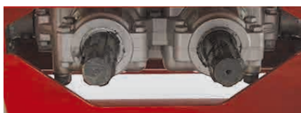
Centralni reduktor z dvojnimi priključnimi nastavkom za hitre in počasne nastavitve diska
