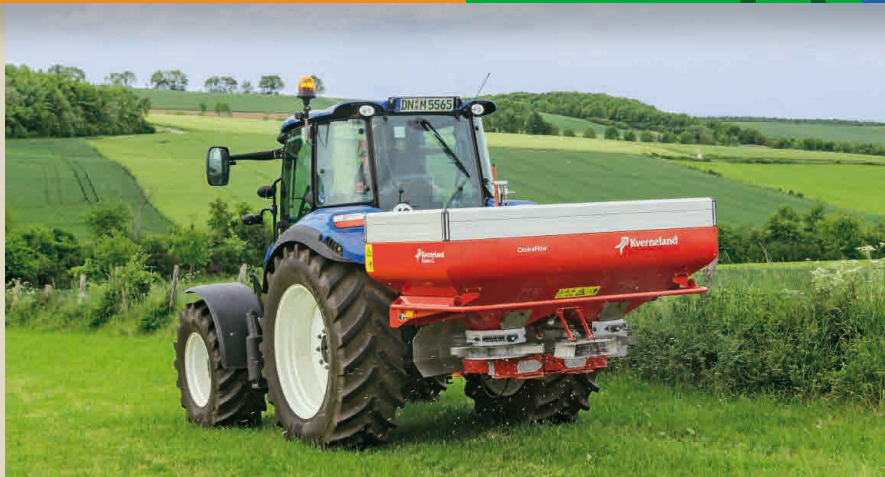
Obmejno trosenje s pomočjo obmejne trosilne plošče (na voljo ročna ali hidravlična različica)
