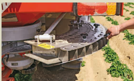
Sistem obmejnega trosenja ExactLine (brez EL)
