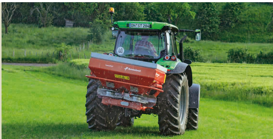
Obmejno trosenje z nagibnim cilindrom
