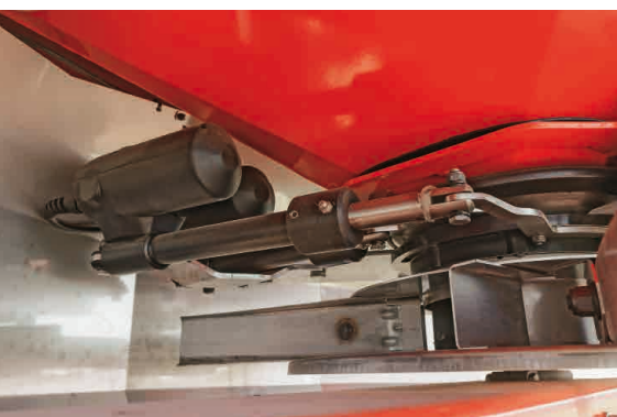
Dva aktuatorja na dozirnih enotah, namenjena nadzoru točke izpusta in stopnje trosenja
