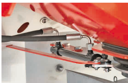
Povezave med hidravličnimi cevmi iz nerjavečega jekla
